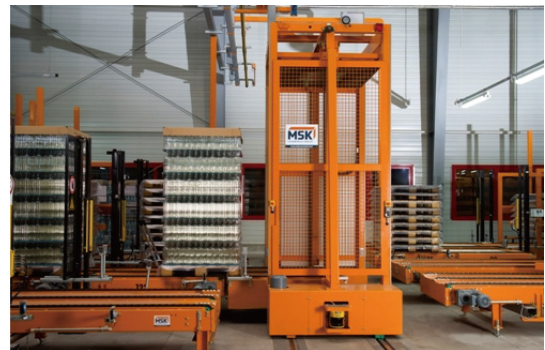
图4 穿梭运输车在码垛、热缩以及空托盘输送线之间的物流
