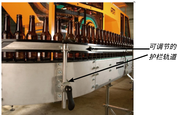
图1 带有可调节的护栏轨道玻璃瓶输送系统
